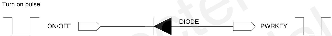
图 8：低电平开机参考电路
